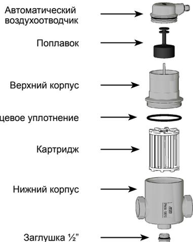
Верхняя часть автоматического воздухоотводчика поворачивается на 360° вокруг своей оси
